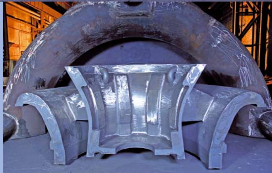
Gas- und Dampfturbine (GuD); Vordergrund: Gasturbinenteil (7 t), Hintergrund: Dampf- turbinenteil (60 t) Gas and steam turbine: foreground: Gas turbine piece (7 t) background: Steam turbine piece (60 t)
