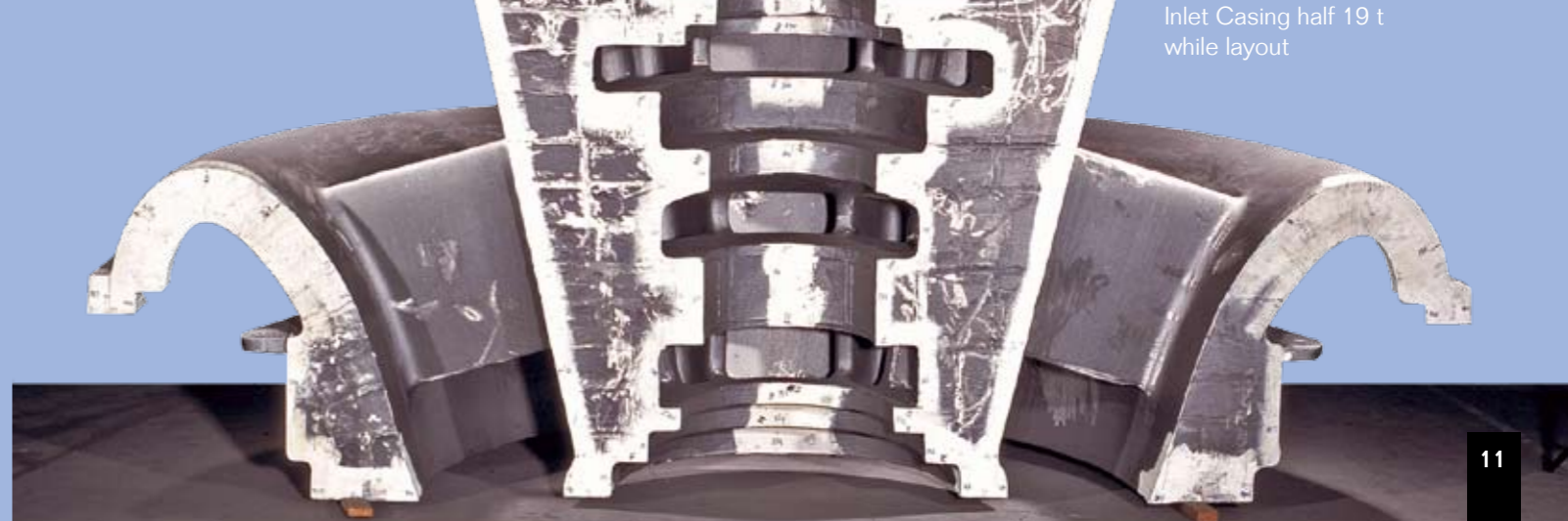
Verdichteransauggehäuse-Hälfte 19 t beim Anreißen
