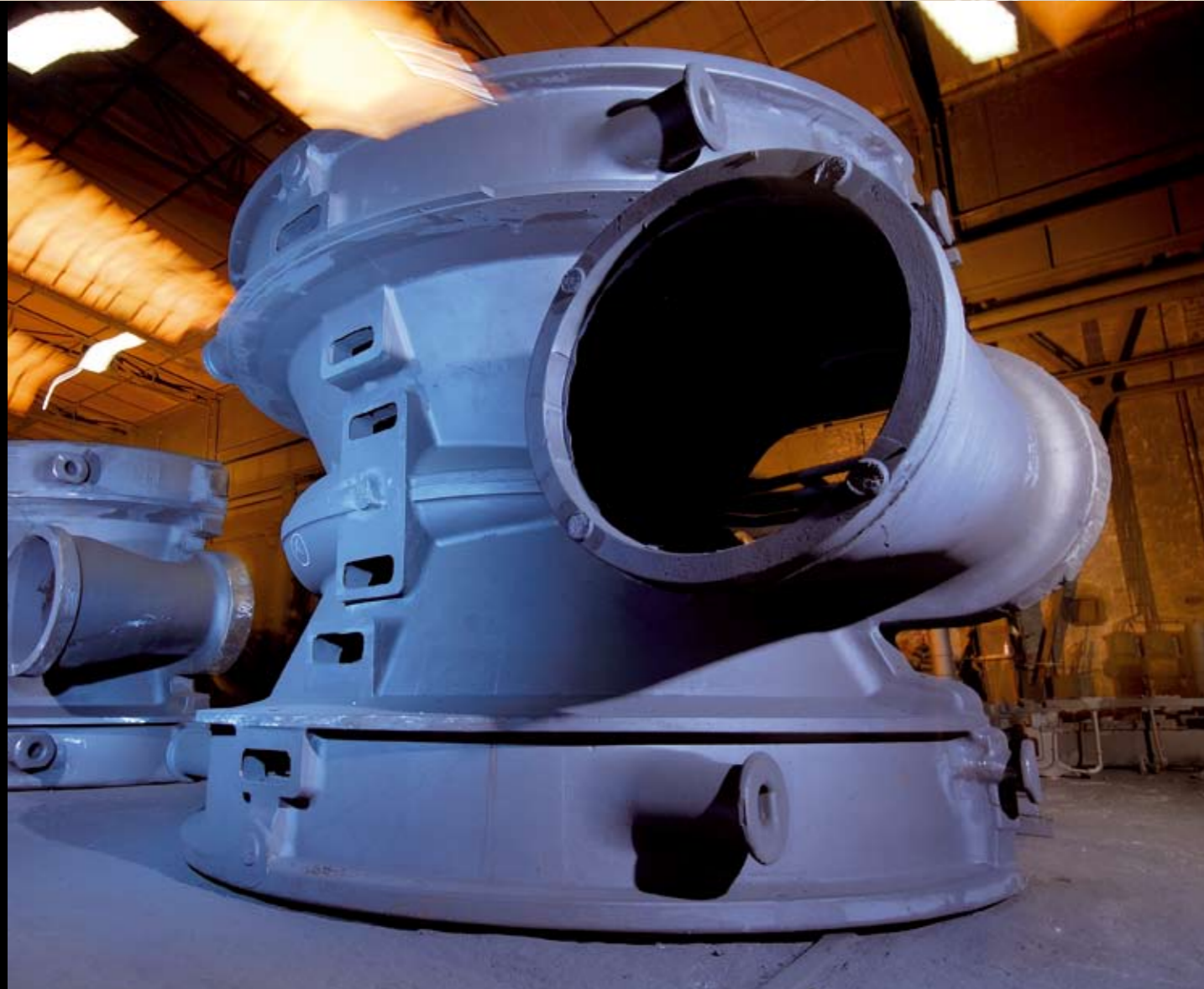
Dampfturbinen-Gehäuse, 45 t Steam Turbine Casing 45 t
